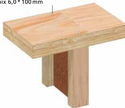
W6 Konstrukční spoj nosníku a prahu pomocí vrtů
