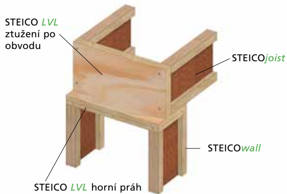
F1 Strop s napojením po obvodu
