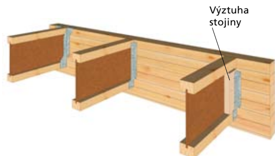
F18 Varianty připojení s tvarovými součástmi Simpson-HWS®
