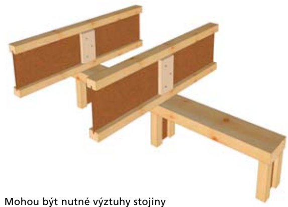
F10 Spojitý nosník na vnitřní stěně
