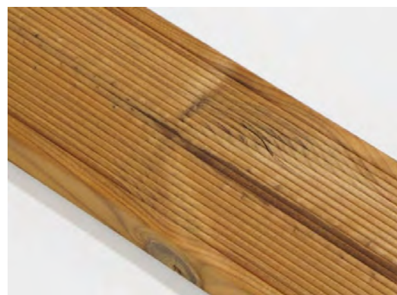
Malé podélné trhliny na povrchu jsou povoleny.
