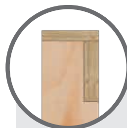
Sloupek s výřezem a s průběžným vazníkem
