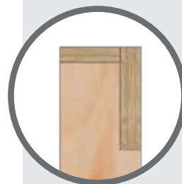
Sloupek s výřezem s průchozím nadokenním překladem a vazníkem
