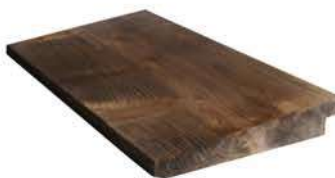
Detail po dokončení procesu šednutí více jak 5 let na přímé povětrnosti
