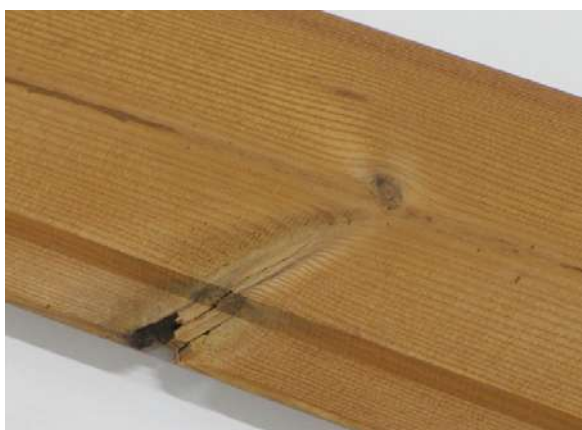
Neviditelné vady po instalaci jsou povoleny.
