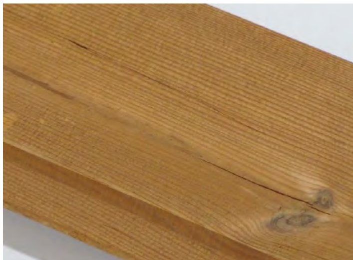
Trhliny na lícni straně do délky 200 mm po výrobě povoleny.
