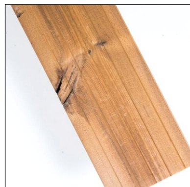
Praskliny kolem suků jsou povoleny
