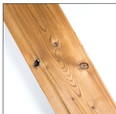
Malé otvory po vypadlých sucích jsou povoleny
