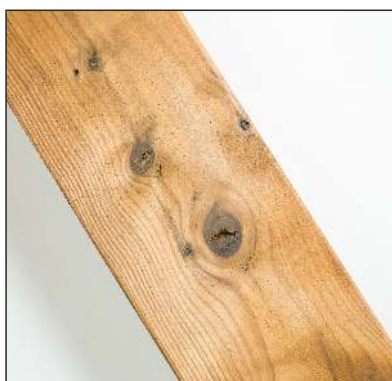
Praskliny v sucích jsou povoleny
